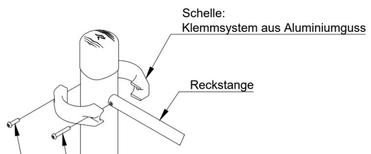
**1. Schritt** - vordere, bzw. größere Schraube M10x65 festziehen.
