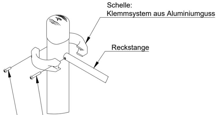
**1. Schritt** - vordere, bzw. größere Schraube M10x65 festziehen.
