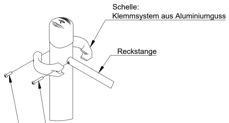
**1. Schritt** - vordere, bzw. größere Schraube M10x65 festziehen.
