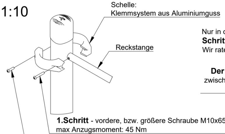
**1. Schritt** - vordere, bzw. größere Schraube M10x65 festziehen.
