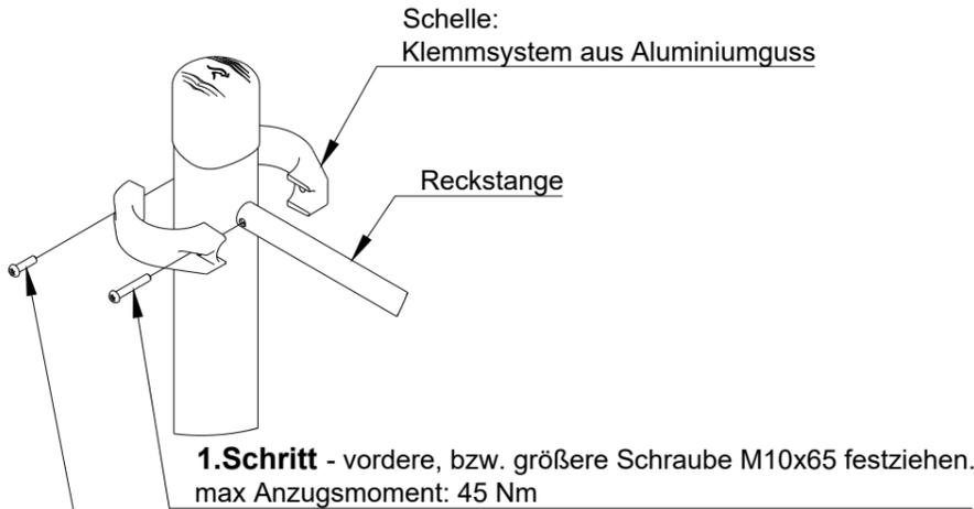
**2. Schritt** - hintere, bzw. kleinere Schraube M10x4 nachziehen
