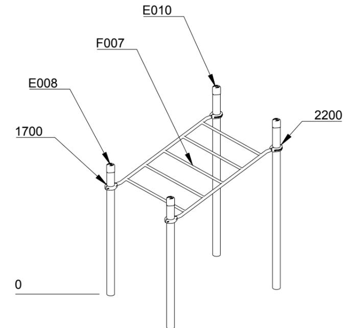
Nur in dieser Reihenfolge müssen die Klemmsysteme befestigt werden. **Schritt Nr. 1 ist der wichtigste Schritt in der Montage des Systems.** Wir raten von gleichzeitiger Fixierung der beiden Schrauben ab.
