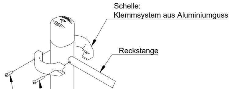
**1. Schritt** - vordere, bzw. größere Schraube M10x65 festziehen.
